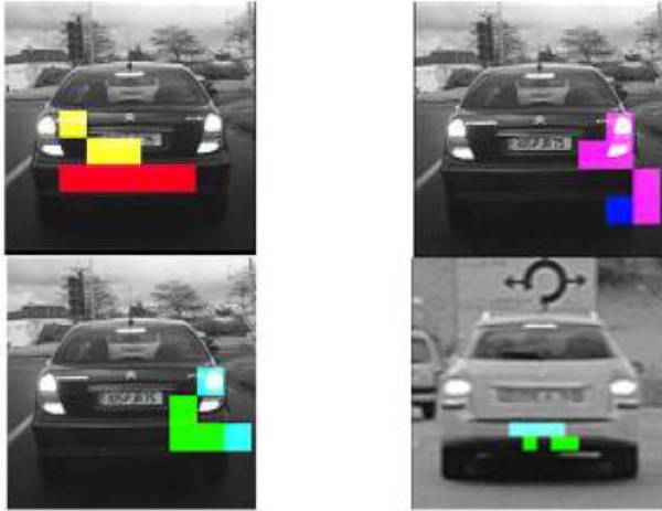
شکل ۶، استخراج ویژگی های جدید بر اساس ۸ نقطه و پیکسل کنترلی متصل بهم را برای شناسایی خودرو استخراج میشود.
